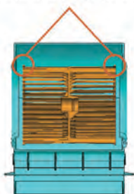
Diseño de la rueda para prevenir el reflujo de aire
